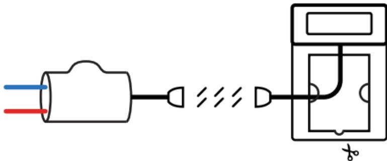
② 连接电源模块及温湿度采集器的端子。采集器下方凹槽可剪开，便于穿线。
