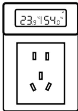
④ 安装插座盖板，通电后设备自动开机检测并上传数据。
