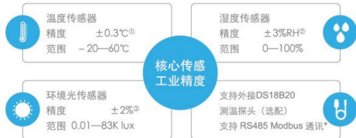
① 0-65°C范围内，温度测量精度为±0.3；② 25°C室温情况下，10-90%RH湿度范围内精度为±3%RH，其余为±4%RH；③ 照度>40 lux，光照测量精度为±2%；实际使用过程中，测量精度会受环境条件、设备摆放方式等因素影响。
