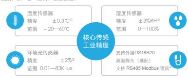
① 0-65℃范围内,温度测量精度为±0.3;② 25℃室温情况下,10-90%RH湿度范围内精度为±3%RH, 其余为±4%RH;③ 照度>40 lux,光照测量精度为±2%;实际使用过程中,测量精度会受环境条件、设备摆放方式等因素影响。
