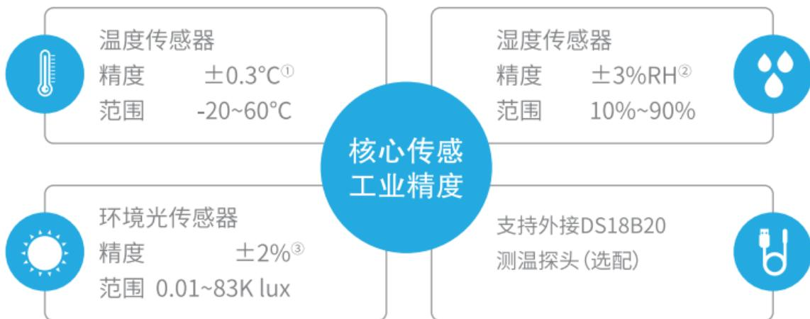
① 0~60°C范围内, 温度测量精度为 $\pm 0.3$ ; ② 25°C室温情况下, 10%~90%RH湿度范围内精度为 $\pm 3\%$ RH, 其余为 $\pm 4\%$ RH; ③ 照度>40 lux, 光照测量精度为 $\pm 2\%$ ; 实际使用过程中, 测量精度会受环境条件、设备摆放方式等因素影响。
