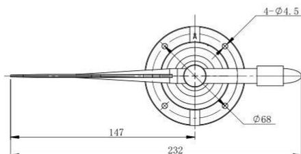
安装孔径： $\phi 4.5$  mm
